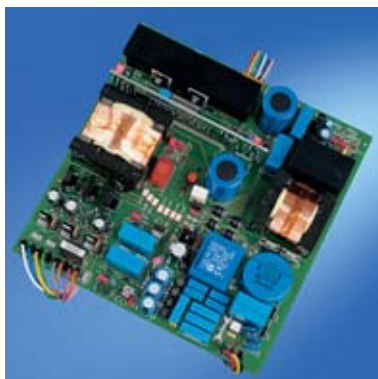
Elektronische Vorschaltgeräte gewährleisten einen wirtschaftlichen und zuverlässigen Betrieb der UV-Strahler
